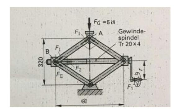
Lösung zeichnerisch: Kräftemaßstab 10 kN=1 cm =>  $F_G$ =1,5 cm Krafteck zeichnen (Dreieck): grüne Linien sind paralell, alle Kräfte im Krafteck drehen in der gleichen Richtung
