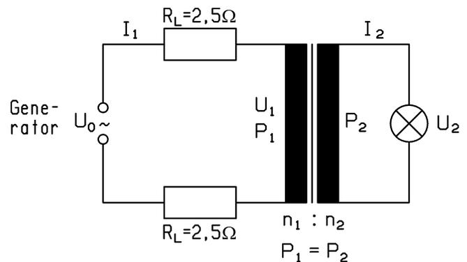
6. Die von einem Kraftwerksgenerator abgegebene elektrische Leistung beträgt  $120\ \text{MW}$  bei einer Spannung von  $30\ \text{kV}$ . Diese Leistung wird über eine Fernleitung mit  $4\ \Omega$  Gesamtwiderstand transportiert. In den Umspannwerken am Kraftwerk bzw. beim Verbraucher werden (angenommen) ideale Transformatoren der Windungszahlen  $n_1 : n_2$  bzw.  $n_2 : n_1$  eingesetzt.
