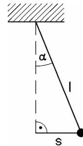
Anm.: Der Ablenkungswinkel  $\alpha$  kann als so klein angenommen werden, dass in der Rechnung  $\sin(\alpha) \sim \tan(\alpha)$  gesetzt werden kann.
